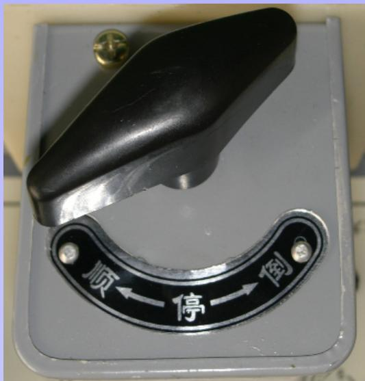
倒顺开关，又叫可逆转换开关，利用改变电源相序来实现电动机手动正反转控制。
