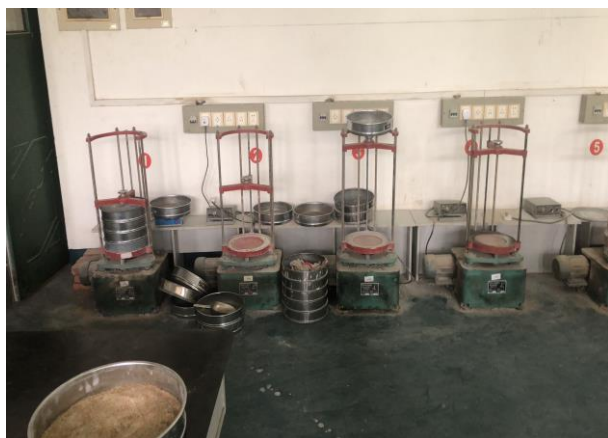
图 2-3 室内筛分试验
