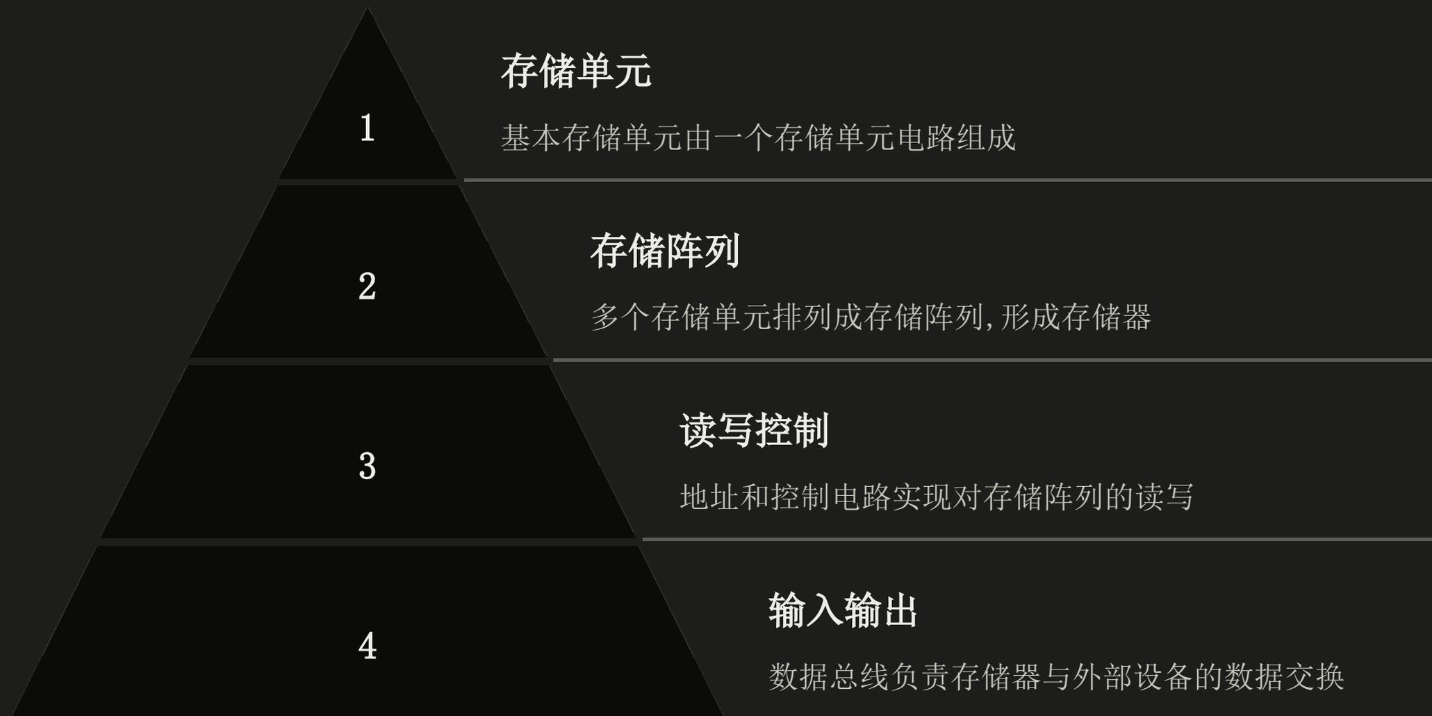
集成电路存储器的工作原理是基于大量存储单元电路构成存储阵列, 通过地址和控制电路实现对存储单元的选择和读写操作。存储器与外部系统通过数据总线进行数据交换。不同类型的存储器如SRAM、DRAM、ROM等在实现方式上略有区别。
