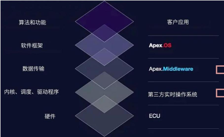
图：汽车智能驾驶软件层级架构
