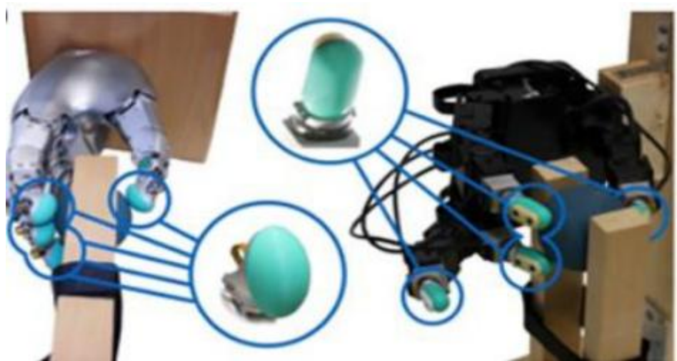
图7.通过触觉稳定器控制物体
