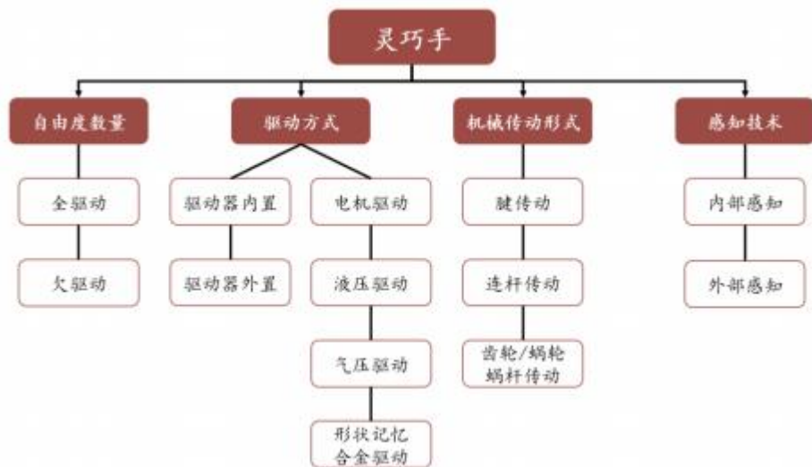
图9.机器人灵巧手的分类
