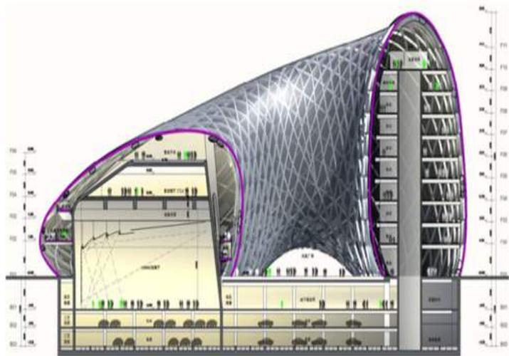
薄壳结构是建筑学上的术语。壳，是一种曲面构件，主要承受各种作用产生的中面内的力。薄壳结构就是曲面的薄壁结构，按曲面生成的形式分为筒壳、圆顶薄壳、双曲扁壳和双曲抛物面壳等，材料大都采用钢筋和混凝土。
