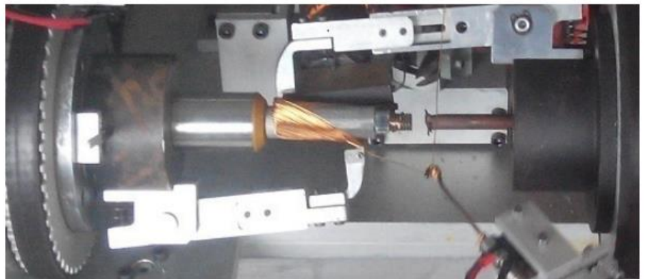
图 22：一次成型绕线过程
