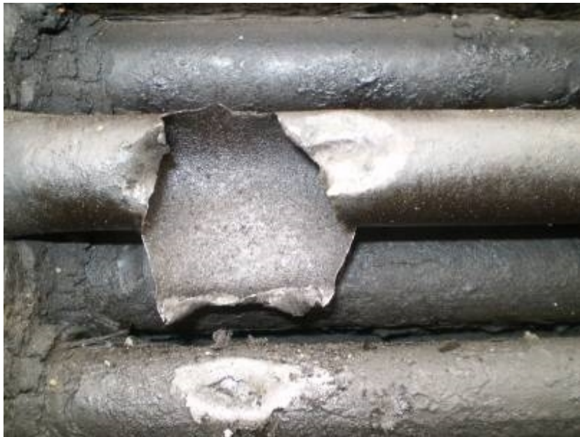
渣油换热器管束腐蚀减薄
