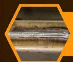
对于高强度铝合金,需要进行焊前预热和焊后热处理
