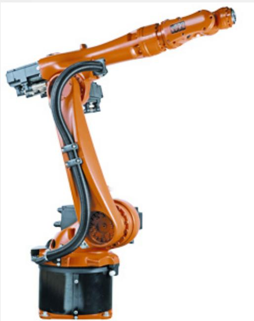
2010年，KUKA推出 KR 5 arc HW（Hollow Wrist），其机械臂和机械手上有一个 50 mm 宽的通孔，可以保护机械臂上的整套保护气体软管的敷设。
