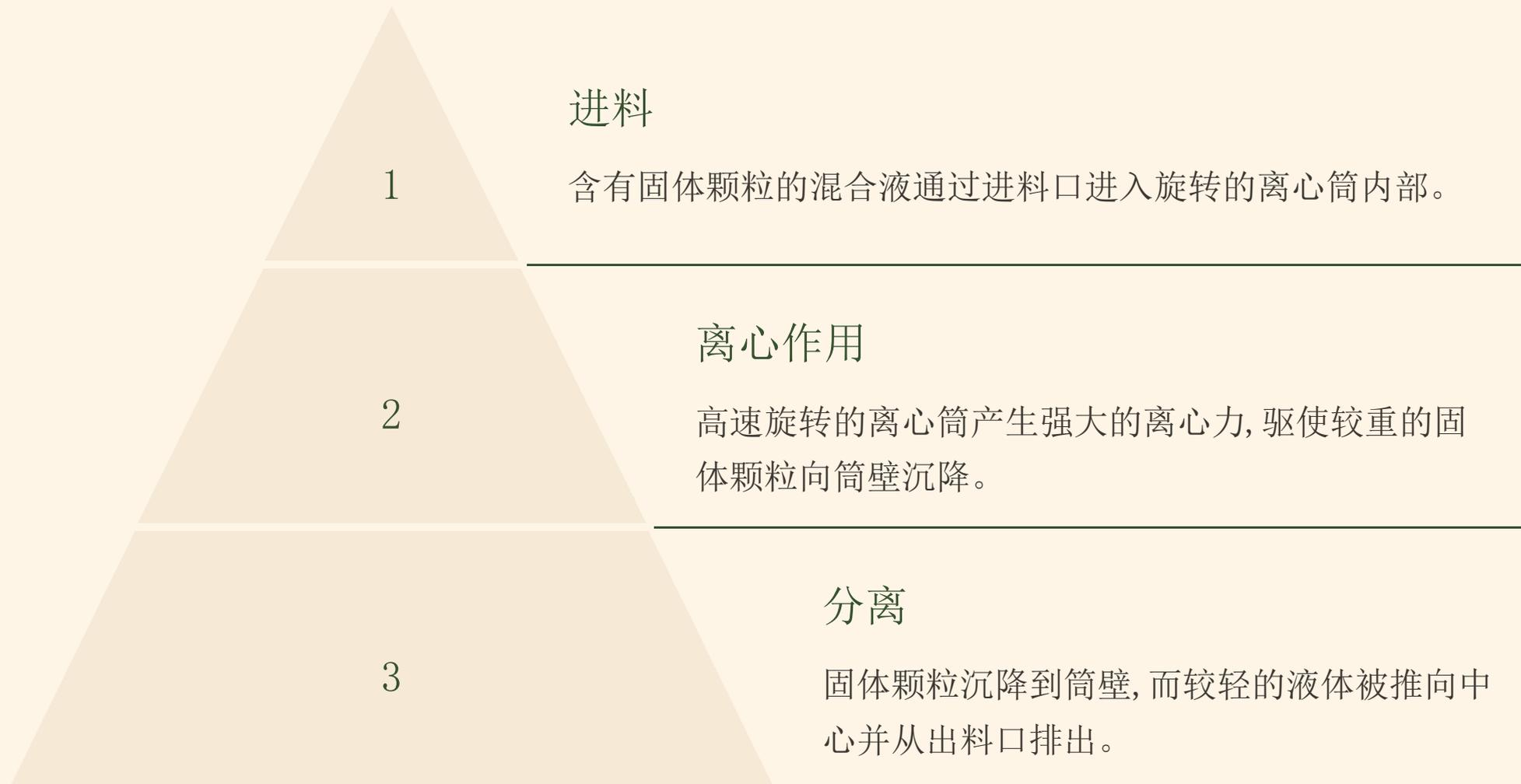
离心式沉降分离设备利用高速旋转产生的强大离心力来实现固液分离。进料后, 较重的固体颗粒会在离心力的作用下迅速沉降到容器壁上, 而较轻的液体则被推向中心并从出料口排出, 从而完成高效的固液分离过程。整个过程快速高效, 适用于处理含有较细小悬浮颗粒的混合液。
