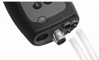
Die Druckbuchsen p+ und p- können nur bei Geräten mit der Option „Druck/Strömungsmessung“ verwendet werden.
