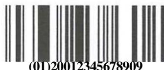
图 8 GS1 DataBar-14 条码符号示意图
