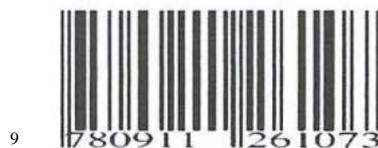
图 4 EAN-13 条码符号示意图
