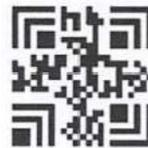
图10 汉信码符号示意图
