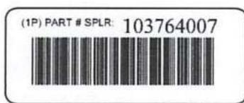
图 1 带DI的条码符号示意图
