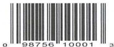
图 3 UPC-A 条码符号示意图
