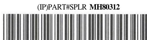
图 6 三九条码符号示意图
