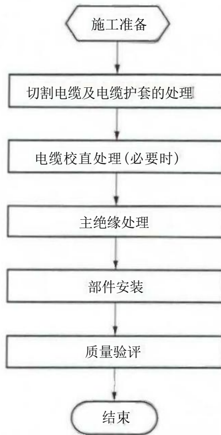
图4.0.1 电缆附件安装工艺流程图
