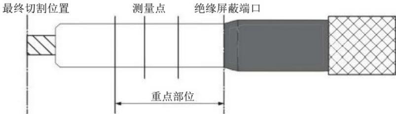
图5.3.6 电缆绝缘表面直径测量
