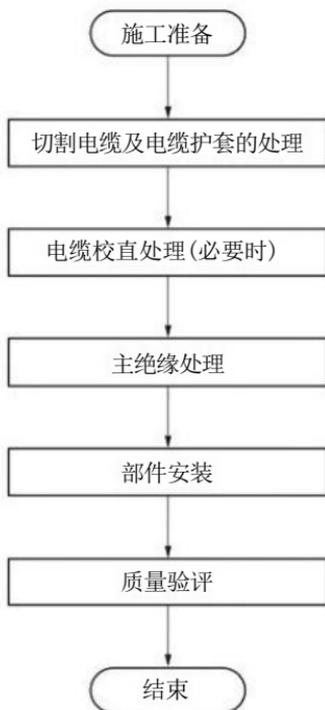
图4.0.1 电缆附件安装工艺流程图
