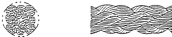
图 3 八股绳索(E型)的形态图
