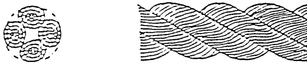
图 2 四股绳索(B型)的形态图
