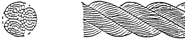
图 1 三股绳索(A型)的形态图
