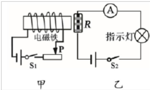
(1) 先闭合开关  $S_2$ ，指示灯不亮，再闭合开关  $S_1$ ，指示灯发光，说明  $R$  的阻值大小与磁场\_\_\_\_（选填“有关”或“无关”）。
