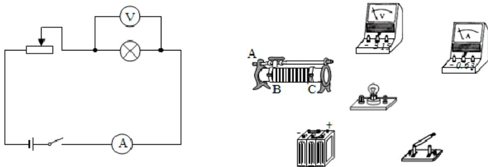
(1)根据该电路图把图中的器材连接成实物图，要求滑动变阻器滑片P向C端移动时，接入电路的电阻变大。
