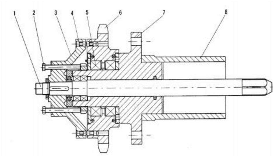
1—传动轴；2—顶开螺栓；3—传动体；4—安全销；5—轴承；6—链轮；7—轴承座；8—连接体
