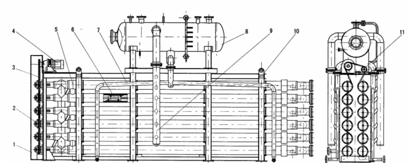
1—头架；2—传动头；3—链条；4—电动机及减速机构；5—套管；
