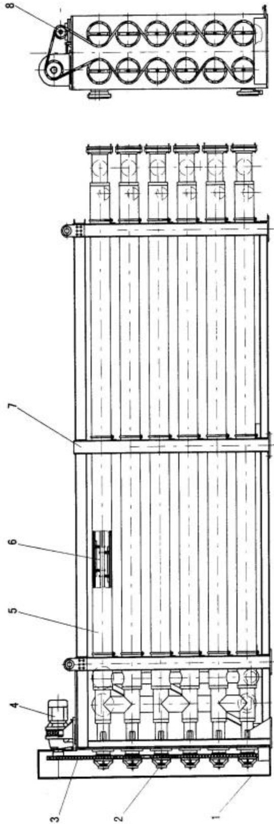
1—头架；2—传动头；3—链条；4—电动机及减速机构；
