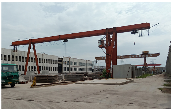
预制场两台 30T 龙门吊装车图
