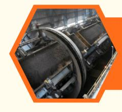
浮选是核心环节,通过添加捕收剂和调整矿浆性质,使高硫矿物与气泡 结合并上浮至矿浆表面。精矿处理包括脱水、干燥和运输等步骤,以实 现资源的有效利用。
