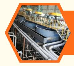
浮选脱硫的工艺流程包括破碎、磨矿、调浆、浮选和精矿处理等环节。
