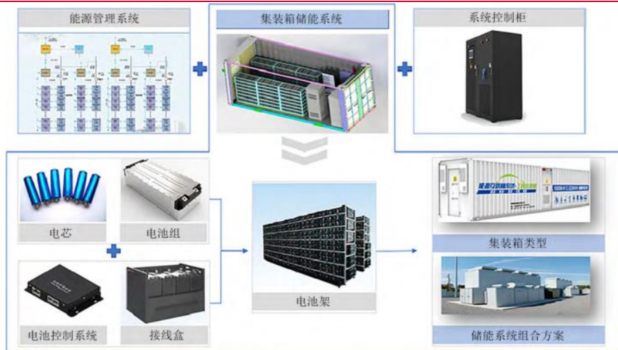
图表32：储能电站结构示意图
