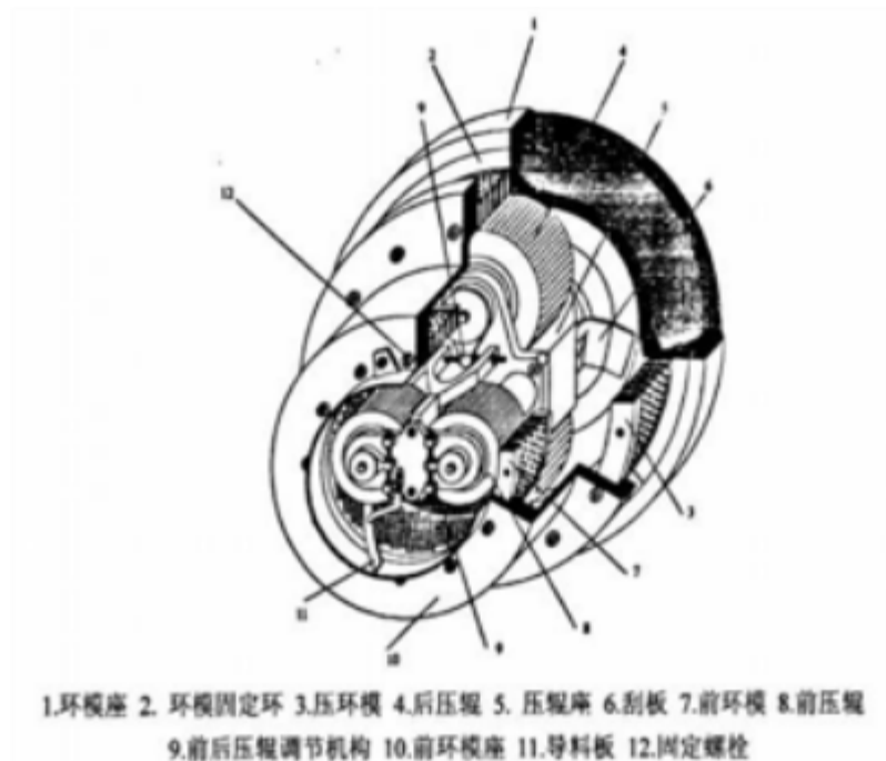
图 1-5 前后组合双环模颗粒制粒机的构造
