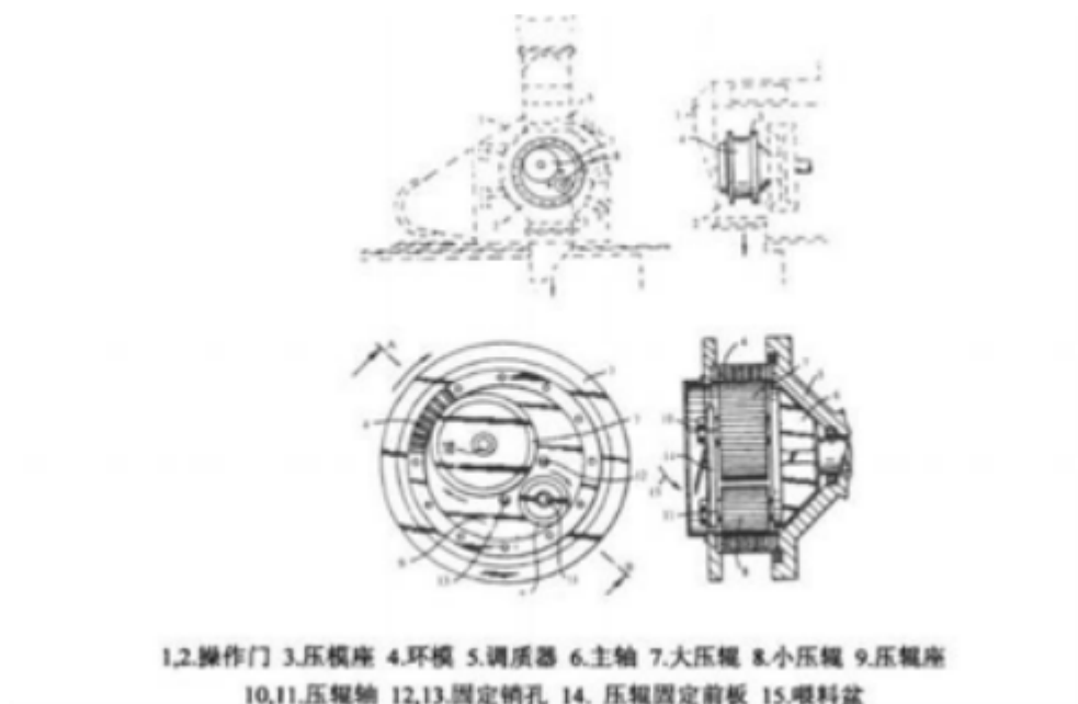
图 1-4 大小压辊环模颗粒制粒机构造
