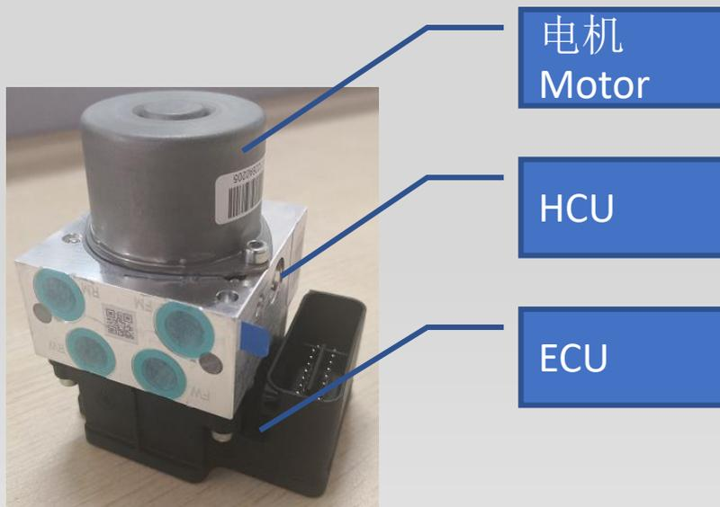
**备注：图示为ABS总成，不允许拆检和部分更换，需整体进行更换，赛福对分解后的ABS不保修，对拆检或者部分更换/互换ABS ECU/HCU后所造成的不良后果不负任何责任。**
