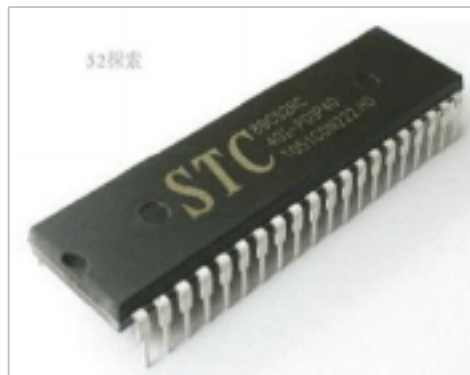
图 2.3 STC89C52 单片机的 DIP40 封装图
