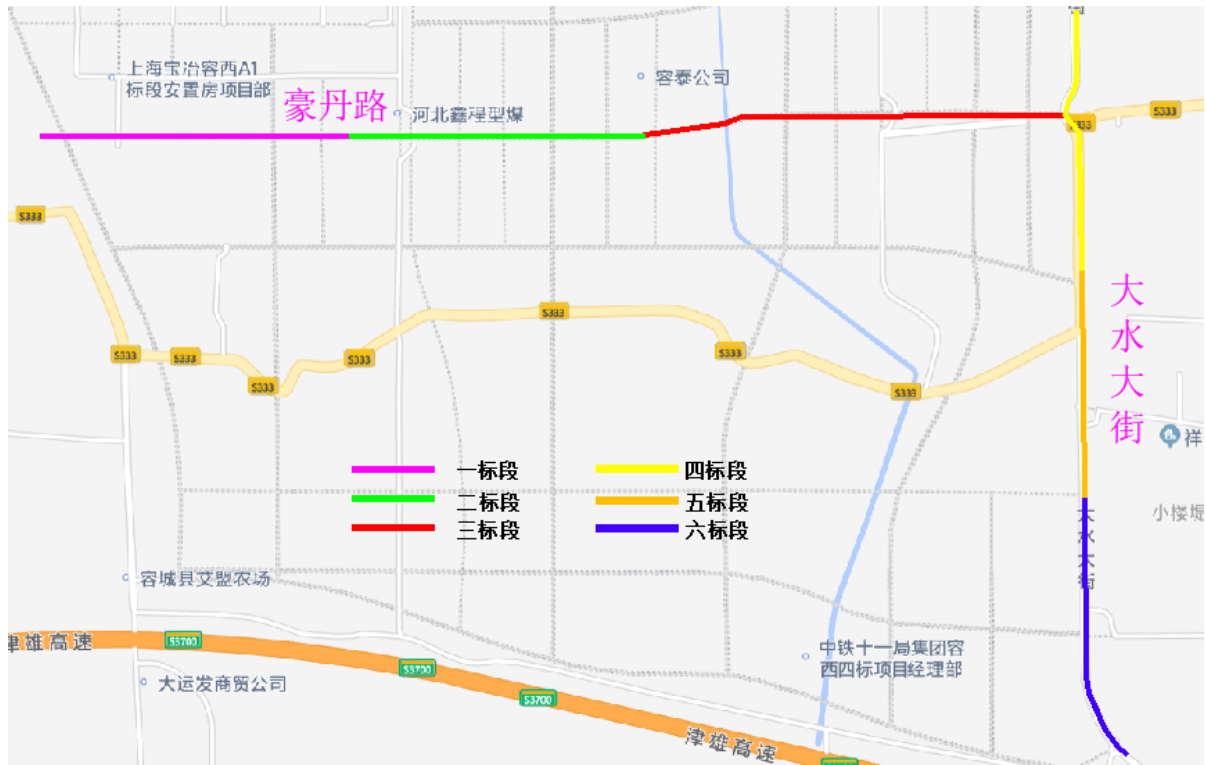
图 3.4.1 现场施工区段划分
