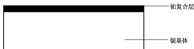
图 1 Pt/Nb 复合阳极板截面形状示意图
