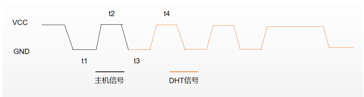
图 3-3 DHT11 传输时序图
