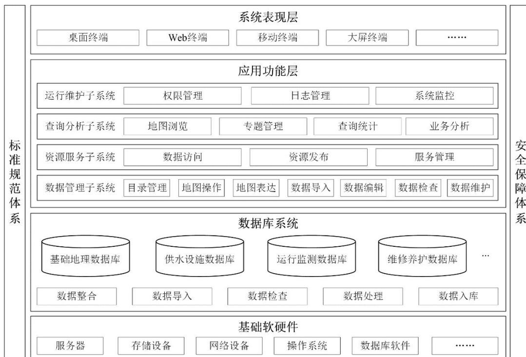
图 4.3.1 供水管网地理信息系统总体架构
