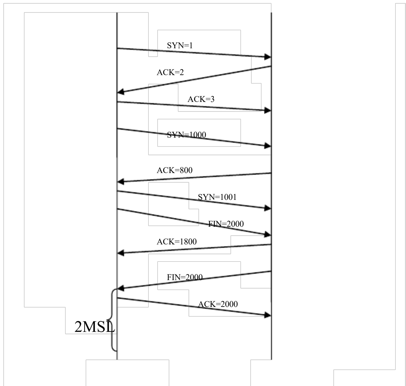
图 2 TCP 连接中分组交换以及客户端与服务器的状态转换
