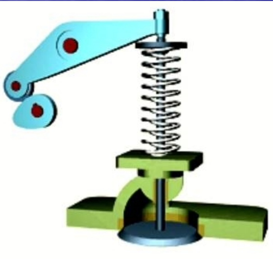
凸轮1、从动件2、机架、锁合装置4
