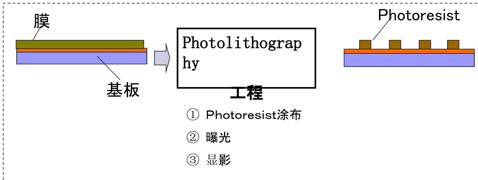
图10 PR工程示意图
