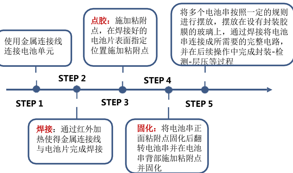
图表：焊接点胶工艺流程及摆串方式
