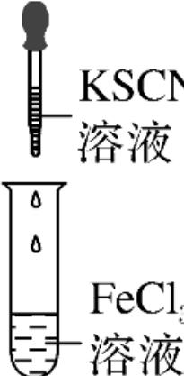
KSCN溶液<br>FeCl <sub>3</sub> 溶液 | 加入KSCN溶液后，溶液呈红色 | Fe <sup>3+</sup> 遇KSCN溶液时，溶液变成红色 | $\text{Fe}^{3+} + 3\text{SCN}^- \rightleftharpoons \text{Fe}(\text{SCN})_3$ |
