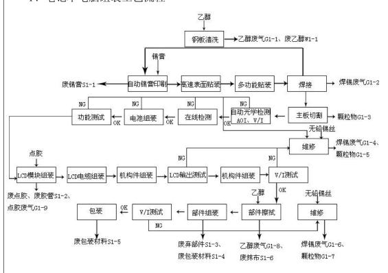
图 1 现有项目笔记本电脑组装工艺流程图
