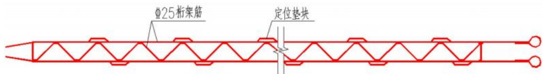
图 5.2.3-6 纵向桁架筋大样图
