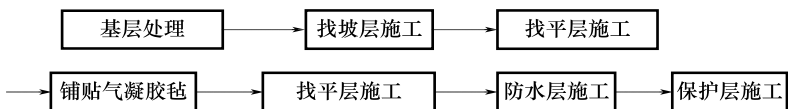
图 6.5.1-1 设置在混凝土屋面的气凝胶毡屋面保温系统施工工序图
