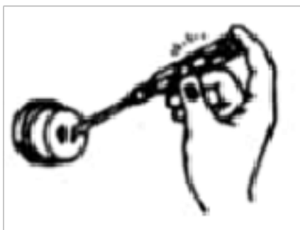
B.用试电笔检测插座是否有电
