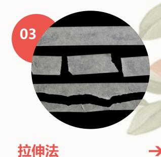
对粘合后的试样进行拉伸 测试,测量拉伸强度以评 估粘合性能。
