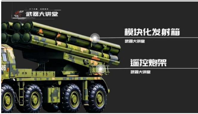
图 6: PCH-191 型远火最特别的两点是“模块化”和“共架发射”
