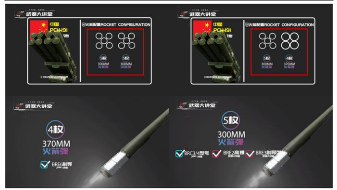
图 7: 采用共架发射技术的 PCH-191 可同时搭载不同口径的弹药
