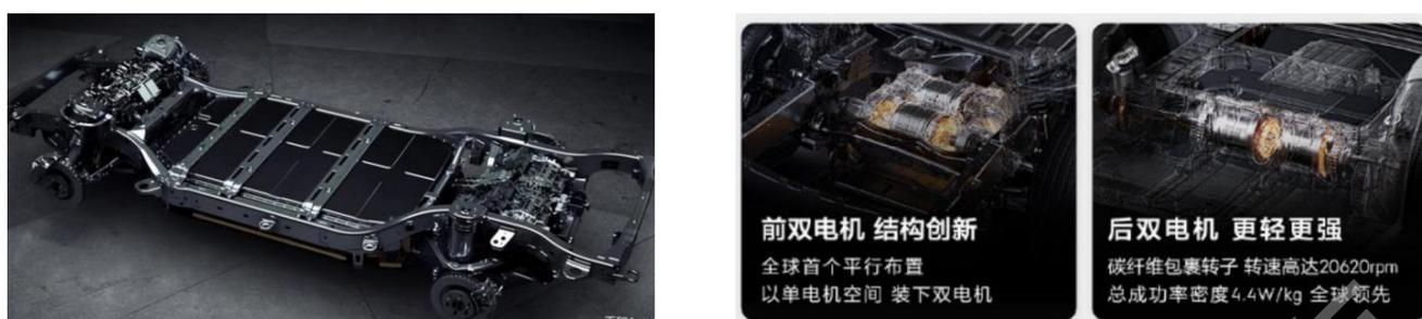
纯电动商用车平台逐步量产，底部换电应用于电动重卡。2023年，奔驰、三一、远程、时代新安、悠跑科技、前晨商用车、Lightning eMotors、LEVC、WEVC等国内外新旧势力企业纷纷发布基于滑板底盘轻型商用车平台战略和产品。4.5吨以下VAN产品滑板底盘化开发主要是将同轴式驱动桥和电池与底盘进行CTC方式集成，并去除中央驱动轴，通过最小改动达到改善整车运力空间和性能，可实现体积减少25%，重量减少15%。
