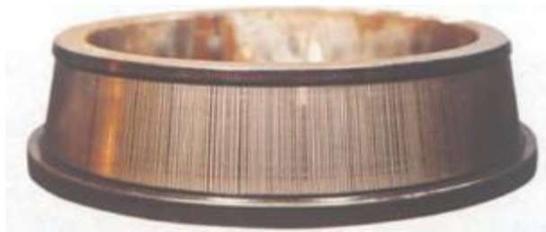
图 23 由于电流泄漏在圆锥滚子轴承内圈滚道上形成的波纹状凹槽(搓板纹)
