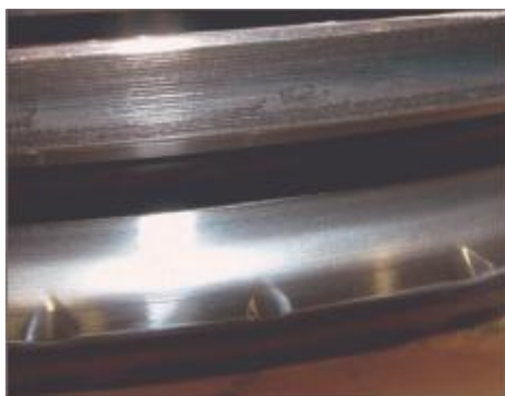
图 26 角接触球轴承静止内圈的过载
