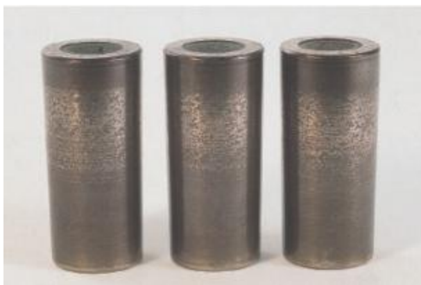
图 31 圆锥滚子上的颗粒压痕
