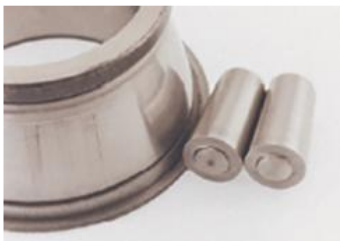
图 10 圆锥滚子轴承滚子大端面和内圈大挡边表面及滚道上的磨粒磨损
