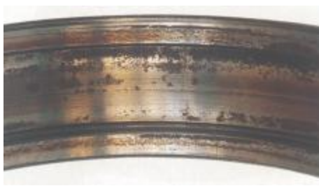
图 15 圆柱滚子轴承外圈滚道上的锈蚀
