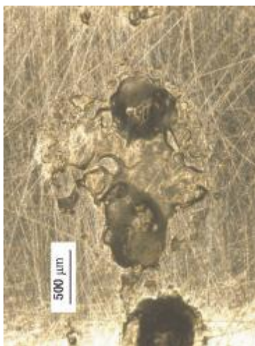
图 21 调心滚子轴承的滚子—由瞬时过大电流通过形成的环形坑
