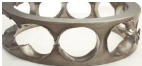
图 9 金属实体保持架兜孔上的已发展的磨粒磨损
