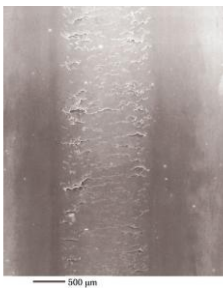
图 6 滚道上的表面起源型微剥落
