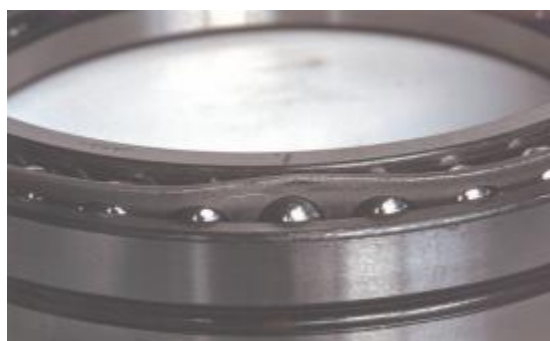
图 27 由角接触球轴承内圈滚道冲击载荷变形导致的剥落,起因于径向冲击,变形进一步发展为剥落
