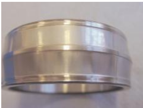
图 8 调心滚子轴承内圈上的磨粒磨损
