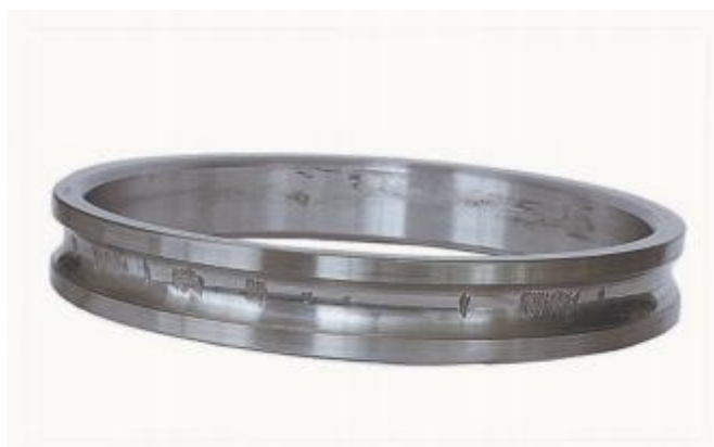
图 26 角接触球轴承静止内圈的过载
