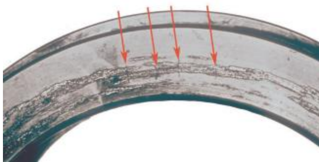
图 37 圆锥滚子轴承内圈小端上的热裂纹
