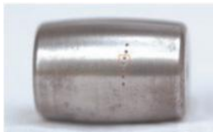
图 21 调心滚子轴承的滚子—由瞬时过大电流通过形成的环形坑
