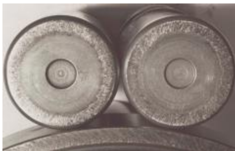
图 13 圆柱滚子轴承滚子端面上的涂抹
