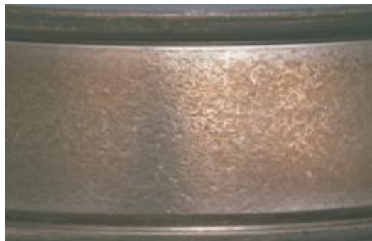
图 30 圆锥滚子轴承内圈滚道上的颗粒压痕
