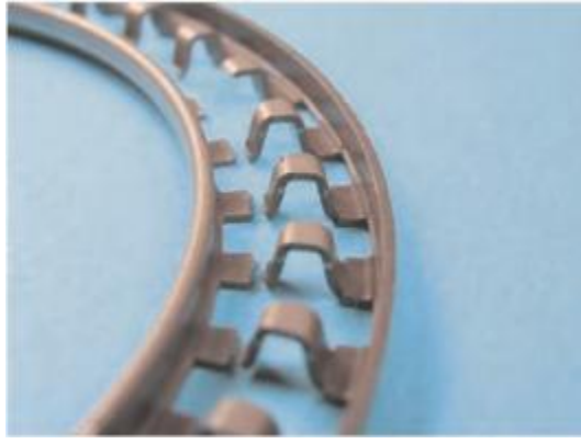
图 36 推力滚针轴承保持架过梁疲劳断裂
