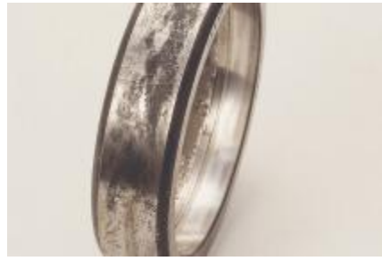
图 18 滚子轴承外径面上的微动磨蚀
