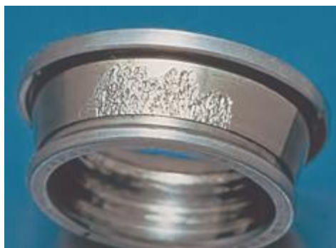
图 3 深沟球轴承旋转内圈上的次表面起源型剥落
