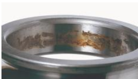
图 17 深沟球轴承内径面上的微动磨蚀
