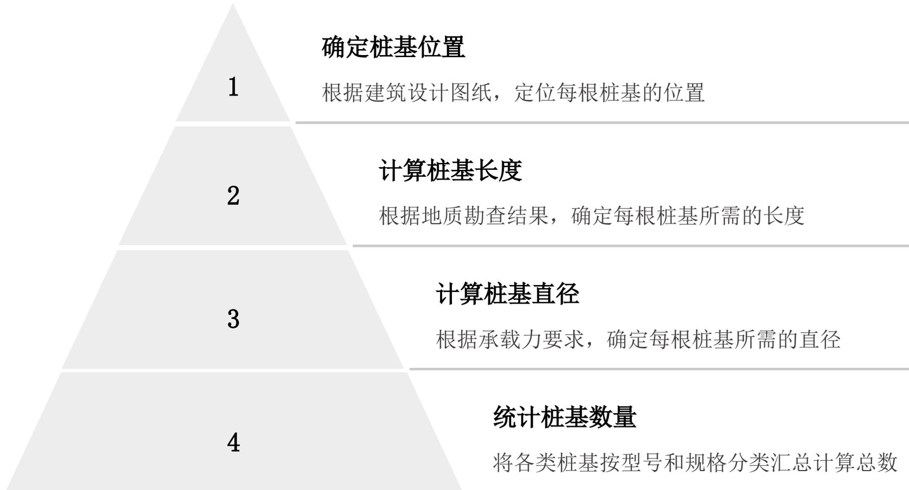
桩基数量的计算是桩基工程量计算的核心内容。首先需要根据建筑设计图纸确定每根桩基的位置坐标。然后根据地质勘查结果和承载力要求分别确定每根桩基的长度和直径。最后将不同规格型号的桩基数量进行汇总统计，得出总桩基数量。这为后续的材料用量计算、工程量清单编制等奠定了基础。
