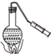
对沸腾的水停止加热，抽气减压，水再次沸腾，说明气压减小沸点降低
