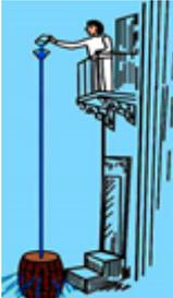
帕斯卡裂桶实验说明液体的压强与液体的深度有关
