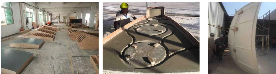
(a) 制作GRG复杂造型模具 (b) 雕刻曲线工艺槽 (c) 硅胶模翻模
