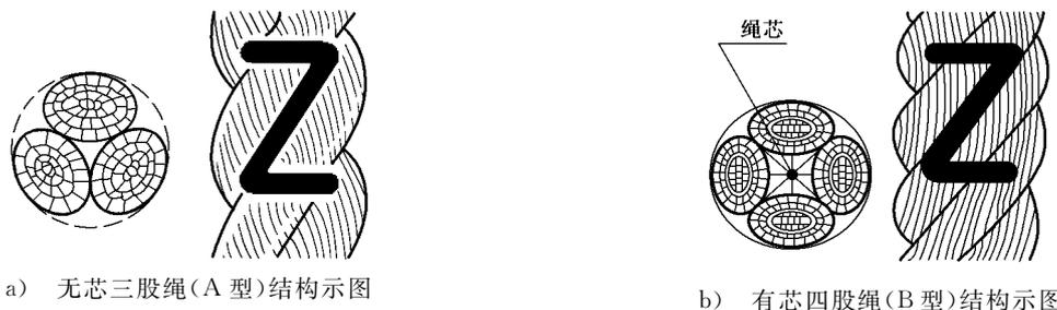
图1 捻绞绳结构示图
