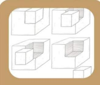
在正视图中,物体的垂直线段与 投影面平行,因此它们在视图中 保持原长度,而水平线段则会缩 短。
