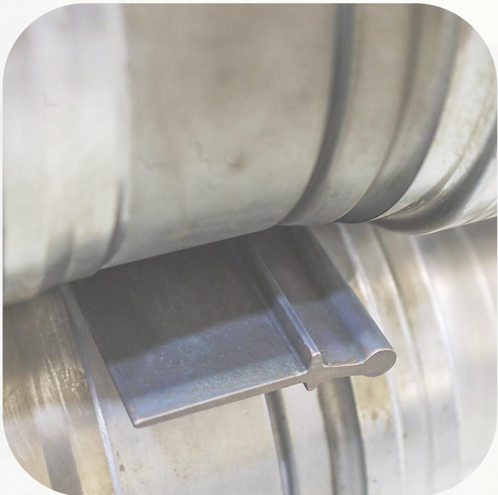
强力旋压成形工艺基于金属塑性变形原理，通过施加外力使金属毛坯发生连续的塑性变形。
