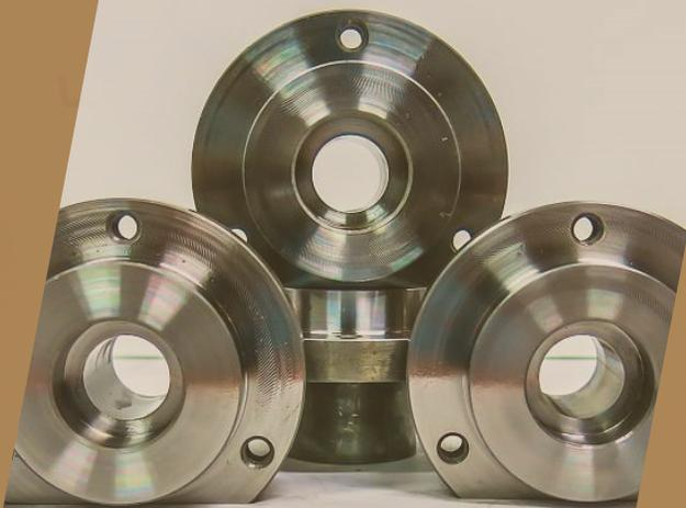
强力旋压成形是一种金属塑性加工技术，通过旋轮在毛坯表面施加压力，使毛坯产生连续的塑性变形，从而形成所需的零件。
