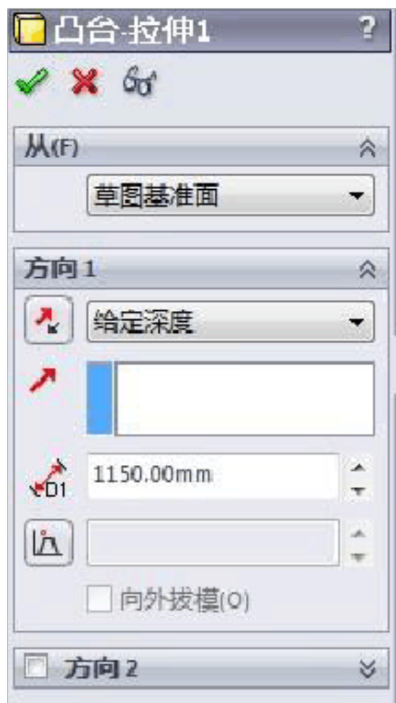
图 3-6 SOLIDWORKS 拉伸功能框
