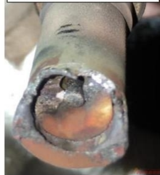
壳体烧穿，材料丢失，陶瓷绝缘体材料丢失。
